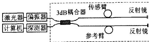
图 1 迈克尔逊型光纤水听器结构示意图
