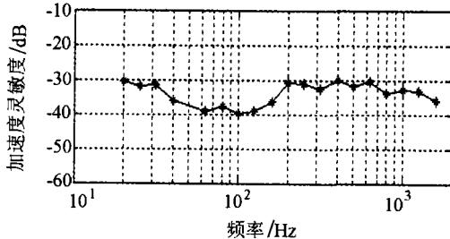
图 3 加速度相移灵敏度随测试频率的变化曲线
