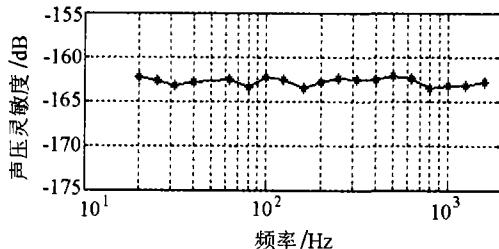
图 2 声压灵敏度随测试频率的变化曲线
