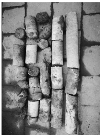
图9 堵漏后钻取的水泥塞
