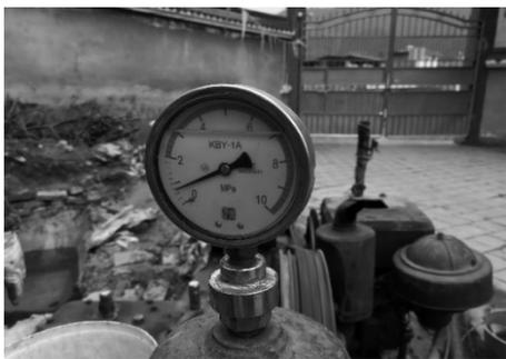
图7 泥浆泵压力下降
