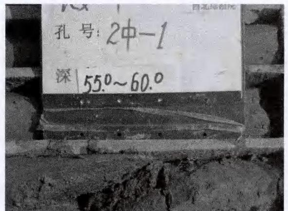
图5 长安二中59.8 m钻探岩芯内断层面
