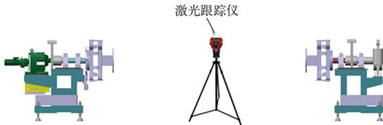
图9 同轴度测量标定示意图
