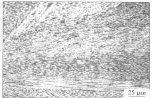
图 3 焊缝边缘的细小柱状晶组织(图 1 中的 b 部分)
