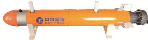
图 2 精灵 M200 水下无人潜航器的实物图
