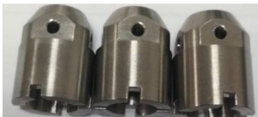
图 10 各项试验后阀芯状态
