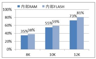
图 5 不同存储器中执行矢量控制算法 CPU 负载率
