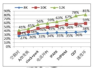
不同 PWM 频率下控制模块 CPU 的负载率 图 4
