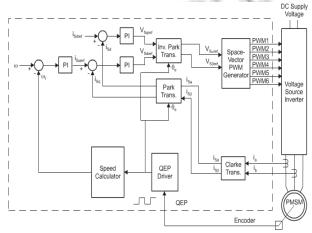
图 1 矢量控制系统结构图
