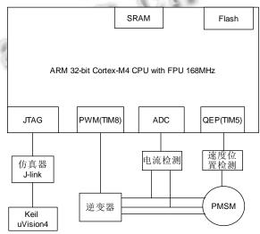
图 2 控制系统硬件总体结构
