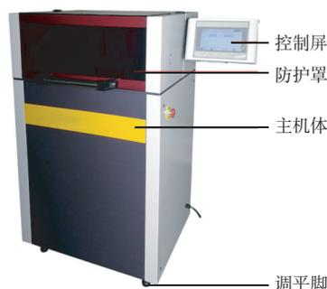
图1 全自动橡塑材料磨样试验机外观
