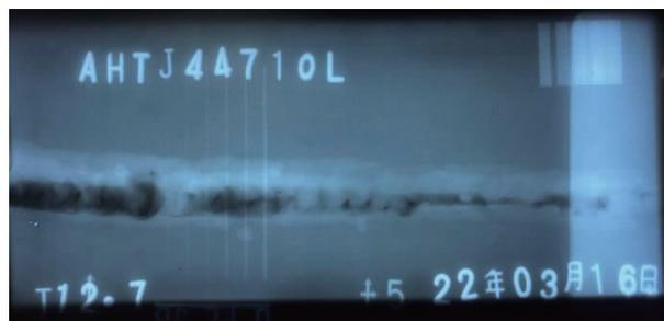
图3 管道环焊缝未焊透缺陷
