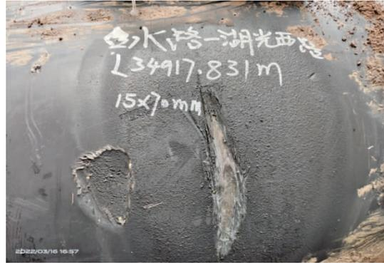
图6 防腐层及管体金属损失
