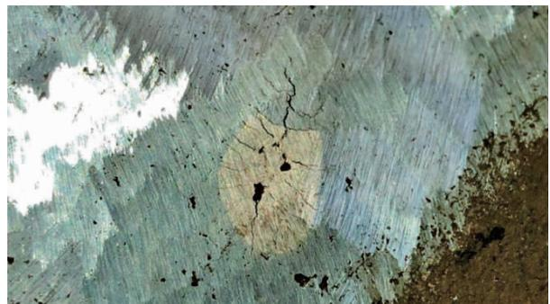
图7 管体龟状裂纹
