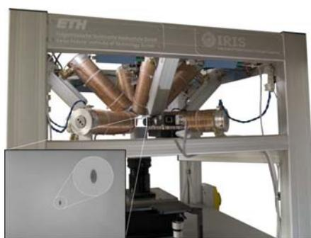
图9 五自由度电磁操控微型机器人
