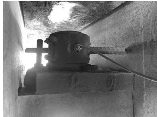
图 2-4 压力传感器安装位置示意图
