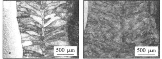
(c) 焊接工艺 I 微观形貌
