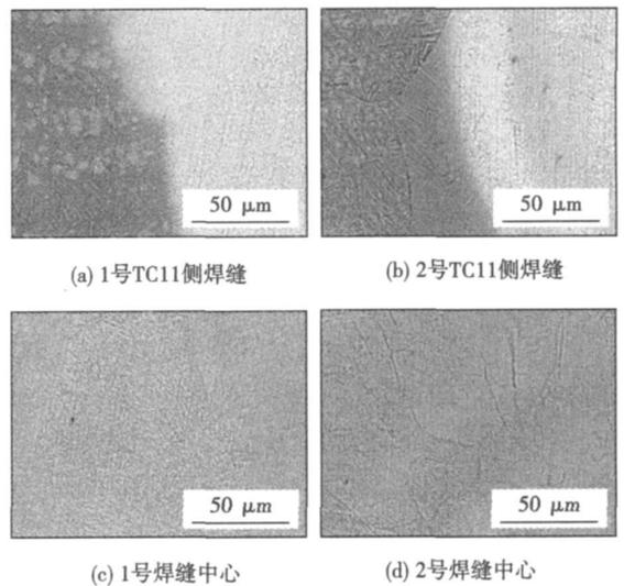
图 4 不同焊接工艺时焊接接头的 SEM 组织
