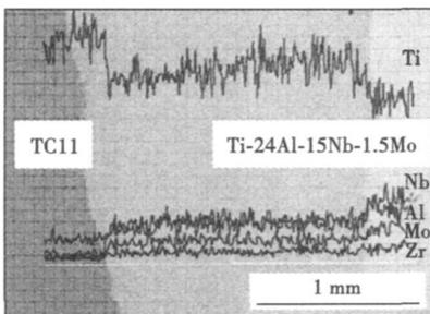
图6 Ti-24Al-15Nb-1.5Mo/TC11焊缝元素扩散的电子探针分析
