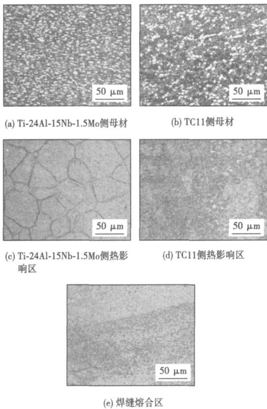
图 3 焊缝区域的微观组织
