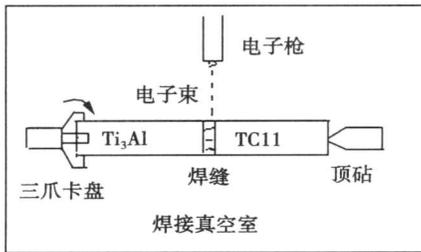
图1 焊接示意图
