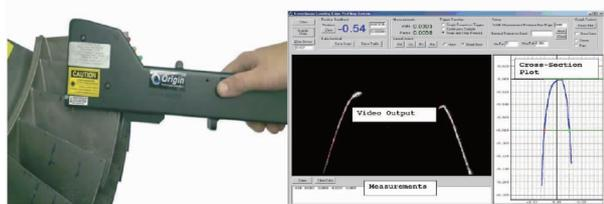
图 4 LMI 叶片进出气边手持式轮廓仪<sup>[48]</sup>
