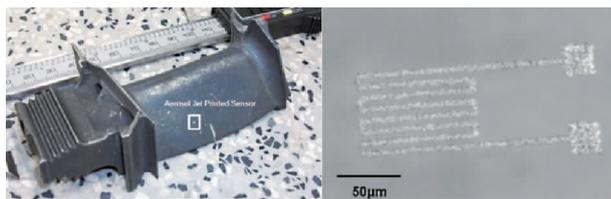
图 13 压气机叶片 3D 打印应变传感器<sup>[74]</sup>
