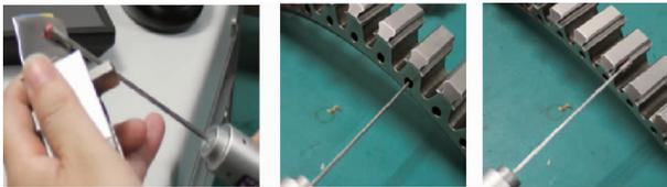
图 8 基于光纤的手持粗糙度仪测量场景<sup>[50]</sup>
