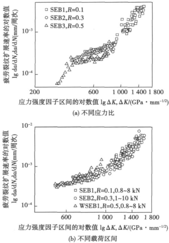
图 3 母材、焊缝裂纹扩展速率与应力强度因子区间关系
