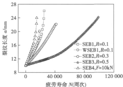
图2 母材与焊缝裂纹长度与疲劳寿命关系
