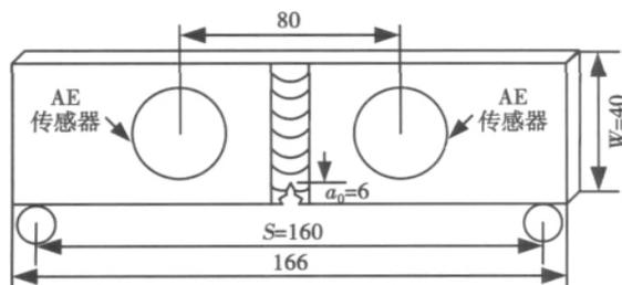
图1 疲劳试样尺寸及形状 (mm)
