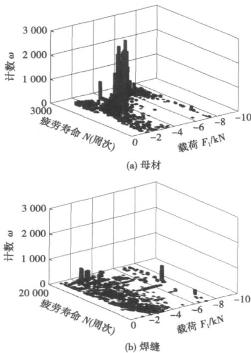
图 4 声发射计数随疲劳载荷和循环次数变化图
