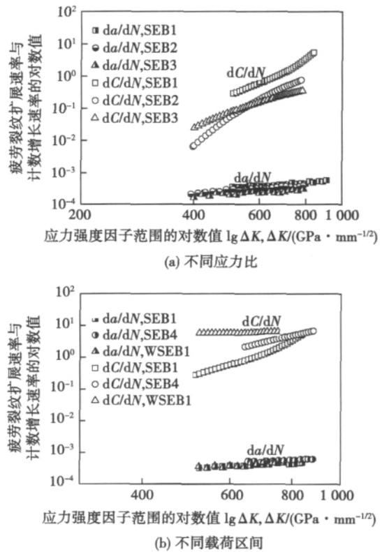
图 5 裂纹扩展速率、AE 计数率与应力强度因子区间关系
