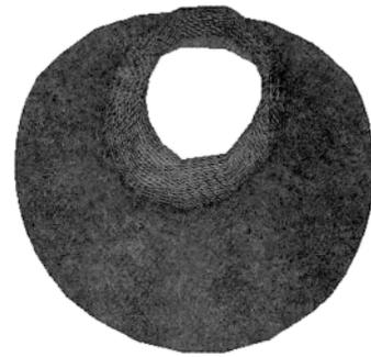
图 12 工作角 -10°时的穿孔熔池背面温度分布
