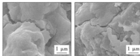
(a) 原始状态 (b) 激光冲击处理后
