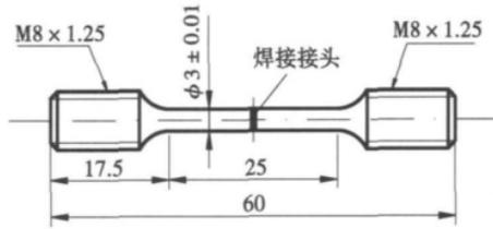
图1 试样尺寸示意图(mm)
