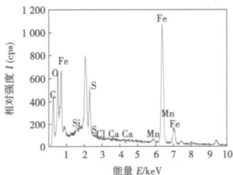
图 5 表面腐蚀物能谱分析
