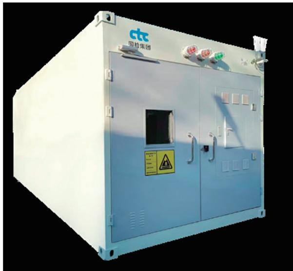
图 1 可移动智能危险废物贮存设施外观照片
