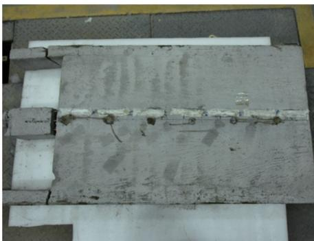
图7 RC桩抗弯破坏( $1.0g$ )
