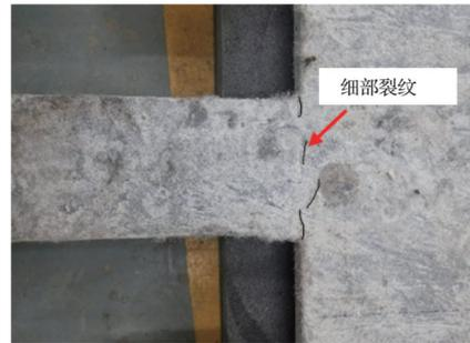
图9 ECC桩板破坏细部图( $1.2g$ )
