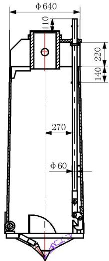
图 10 旋挖钻头
