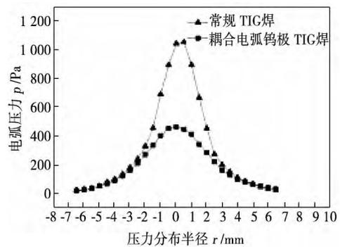
图 4 耦合电弧钨极 TIG 焊与常规 TIG 焊电弧压力比较
