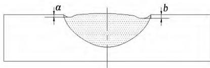
图6 焊缝咬边示意图
