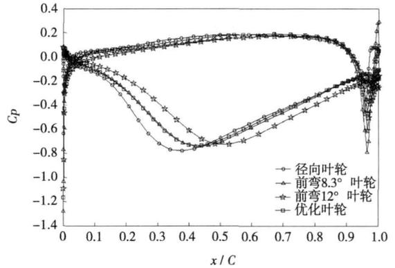
图 7 周向前弯叶轮叶顶区域叶片表面静压系数沿轴向分布
