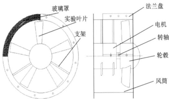
图 4 PIV 实验装置示意图
