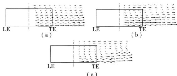
图 10 前弯  $8.3^\circ$  叶轮叶顶区域相对速度分布
