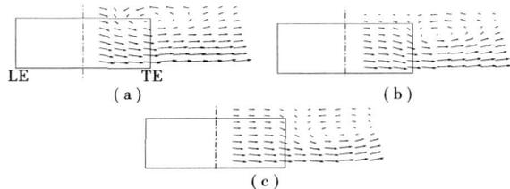
图 11 前弯  $12^\circ$  叶轮叶顶区域相对速度分布
