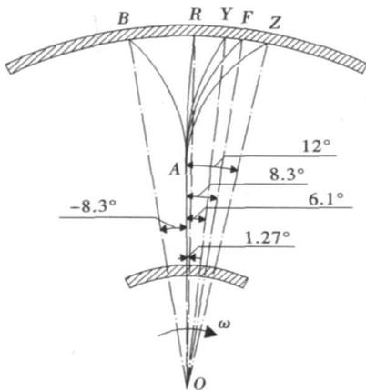
图1 叶片重心积迭线和周向前弯角度
