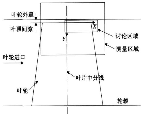
图 6 PIV 测量区域的轴向和径向位置示意图
