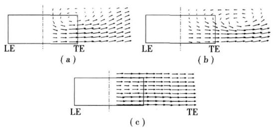
图 8 径向叶轮叶顶区域相对速度分布
